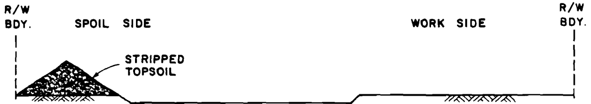
1. TOPSOIL STRIPPED N.T.S.
